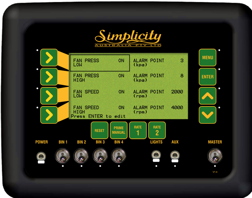
Fan Alarm Screen
